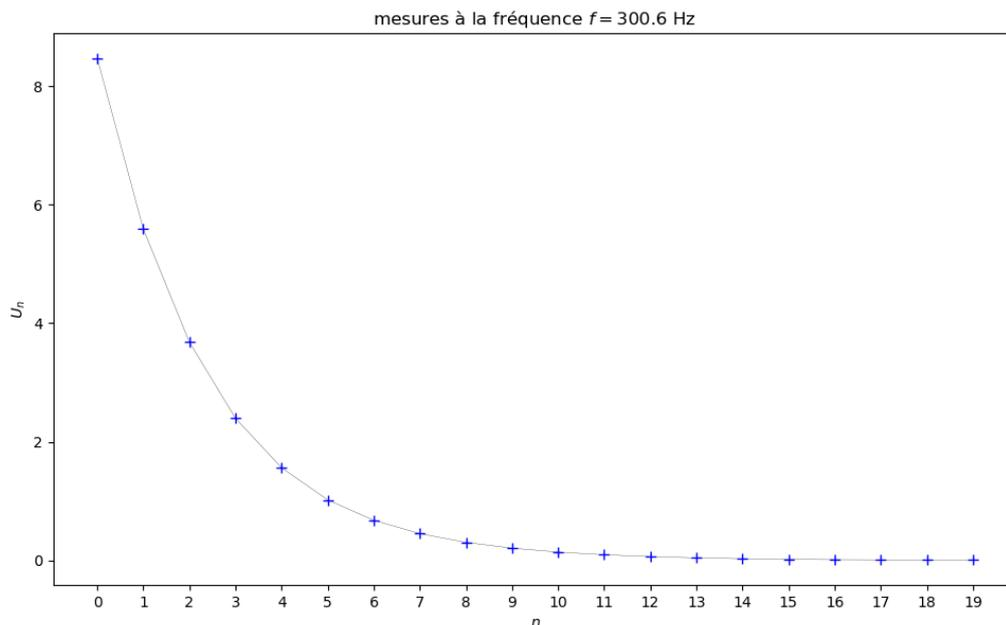
L'amplitude de la tension décroît tout au long de la ligne.
