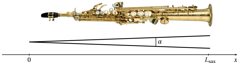
FIGURE I-2 – Saxophone soprano et son modèle de tuyau conique
