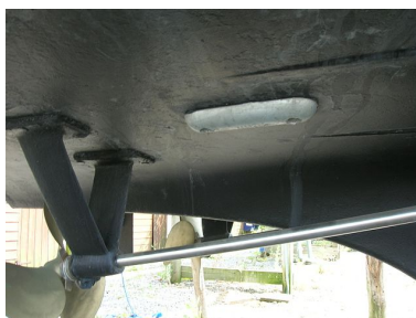
anode sacrificielle neuve
