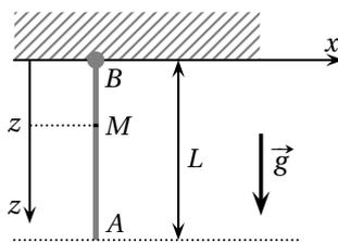
La corde est verticale; l'axe des  $z$  est orienté vers le bas et l'origine est à l'extrémité  $B$ . L'axe  $Ox$  est dans un plan horizontal. La position d'un point  $M$  de la corde est repérée par sa cote  $z$  dans un référentiel galiléen lié à  $B$ .
