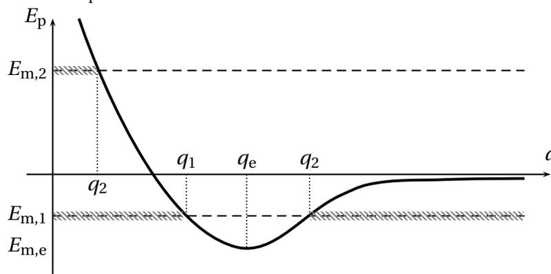
**1<sup>er</sup> cas :** énergie mécanique  $E_{m,1}$ . Les régions  $q(t) < q_1$  et  $q(t) > q_2$  sont interdites. La vitesse est nulle aux positions  $q_1$  et  $q_2$ . Le système a un mouvement périodique : il effectue des oscillations entre  $q_1$  et  $q_2$ . On dit qu'il est dans un **état lié**.
