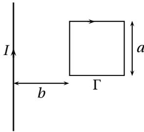
Un cadre  $\Gamma$  carré, de côté  $a$ , est placé à la distance  $b$  du fil, ce dernier étant dans le plan du cadre. Déterminer le flux du champ magnétique  $\vec{B}$  créé par le fil à travers le cadre  $\Gamma$ .
