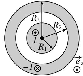
Entre  $R_1$  et  $R_2$  se trouve une matière isolante ayant des propriétés électromagnétiques assimilables à celles du vide. Ce câble, d'axe  $Oz$ , est infiniment long. Sa partie conductrice centrale est parcourue par une intensité  $I$  constante, dirigée selon  $\vec{e}_z$ ; sa partie périphérique est parcourue par l'intensité  $-I$  selon  $\vec{e}_z$ . Dans chacune des deux parties conductrices, la densité volumique de courant est supposée uniforme.
