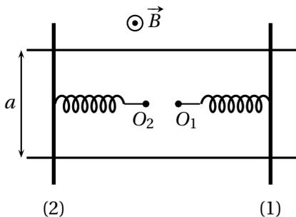
Les conditions initiales sont  $x_1(0) = X_{10}$ ,  $x_2(0) = 0$ ,  $\frac{dx_1}{dt}(0) = \frac{dx_2}{dt}(0) = 0$ . Les positions  $x_1$  et  $x_2$  sont repérées par rapport aux ressorts au repos. Trouver les équations du mouvement et les résoudre en régime permanent (poser  $u = x_1 + x_2$  et  $v = x_1 - x_2$ ).
