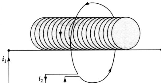
1. Calculer l'inductance mutuelle  $M$  de ces deux circuits, avec les orientations données sur le schéma.
