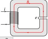
**Champ magnétique.** Conservation du flux, soit  $SB_{air} = SB_{fer}$ . On a donc  $B_{fer} = B_{air}$  **Excitation magnétique.** Théorème d'Ampère :
