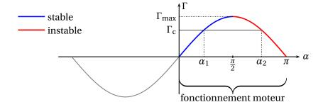
Le fonctionnement est moteur pour  $0 < \alpha < \pi$ . Le fonctionnement est stable pour  $0 < \alpha < \pi/2$ .
