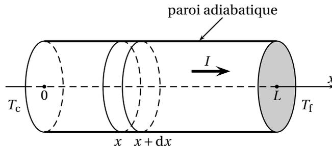
Ce conducteur est également parcouru par un courant électrique d'intensité  $I$  selon l'axe  $Ox$ , uniformément réparti sur la section du conducteur.
