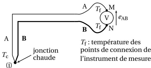
FIGURE I-2 – Thermocouple sans température de référence
