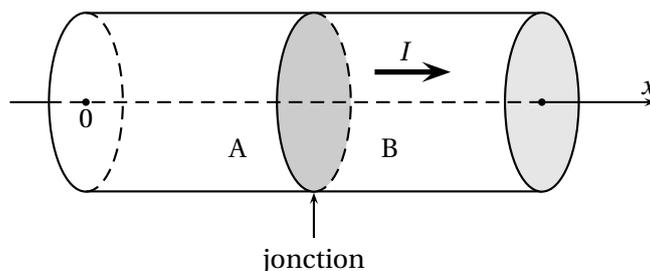
FIGURE I-3 – Effet Peltier à une jonction
