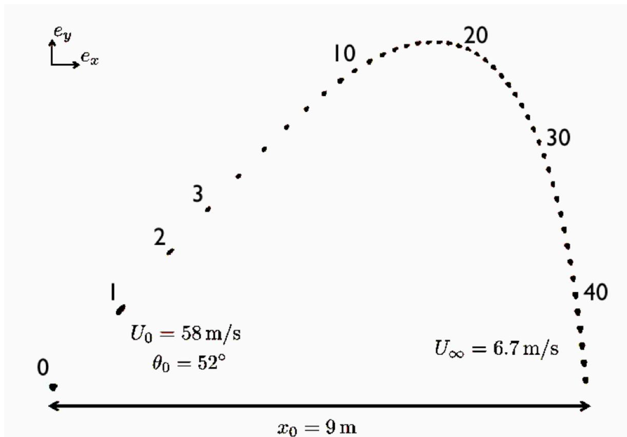
FIGURE 1 – Positions successives d'un volant de badminton allant de la gauche vers la droite, enregistrées toutes les 50 ms. Le premier point, repéré par le chiffre 0, correspond au lancer  $t = 0$ .
