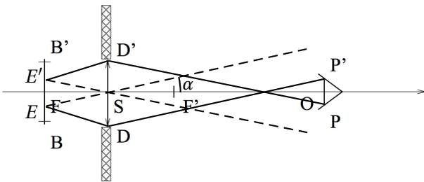
4. On a d'une part  $\tan \alpha = \frac{EE'/2}{SF}$  et d'autre part  $\tan \alpha = \frac{DD'/2 + PP'/2}{SO}$ , d'où
