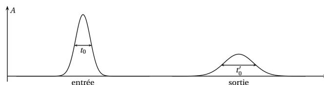
7. En supposant  $t_0$  négligeable devant  $\delta t$ , les impulsions de sortie ont pour largeur  $\delta t$ . L'intervalle de temps entre deux impulsions successives étant  $T = \frac{1}{F}$ , le non-recouvrement des impulsions à la sortie de la fibre optique s'écrit  $T > \delta t$ , soit
