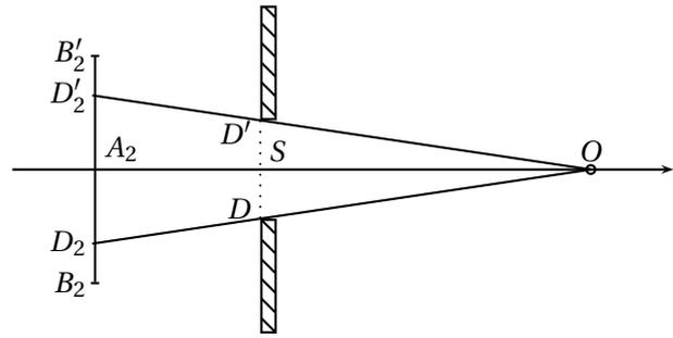
Le diaphragme ne laisse visible que la partie  $D_2D'_2$  de l'image  $B_2B'_2$ , telle que
