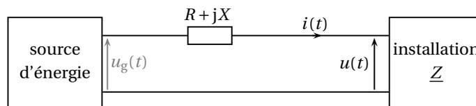
La source fournit la puissance moyenne  $P_g$ ; l'installation consomme la puissance moyenne  $P_u = U_{\text{eff}}I_{\text{eff}} \cos \varphi$  où  $\underline{Z} = Z \cos \varphi$  et la ligne consomme la puissance moyenne  $P_\ell = RI_{\text{eff}}^2$  (pertes en ligne).
