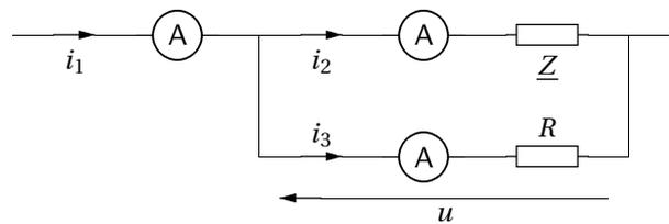
1. En utilisant la loi des nœuds, déterminer le facteur de puissance du dipôle d'impédance  $Z$  en fonction des trois courants efficaces.
