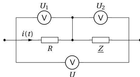
Déterminer le facteur de puissance du dipôle en fonction des indications des voltmètres et en déduire la puissance active reçue par le dipôle.
