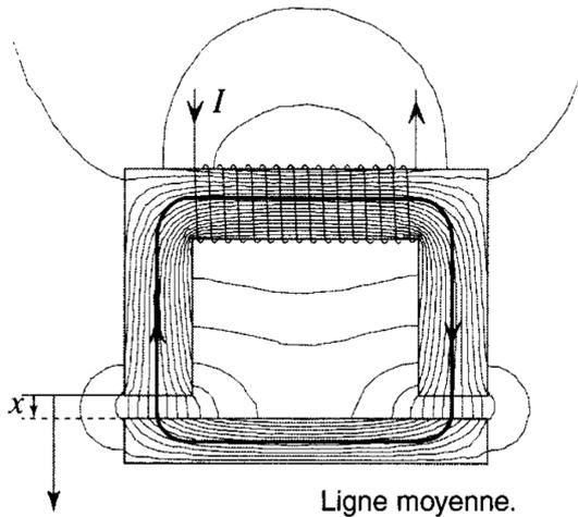
On note  $H_1$  l'excitation dans l'électroaimant,  $H_2$  celle dans la pièce à soulever et  $H_e$  celle dans l'entrefer.
