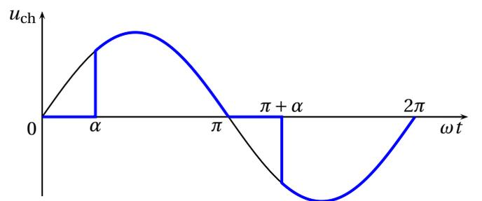
Exprimer la valeur efficace  $V_{\text{eff,gr}}$  de la tension de sortie en fonction de  $A$  et  $\alpha$ .
