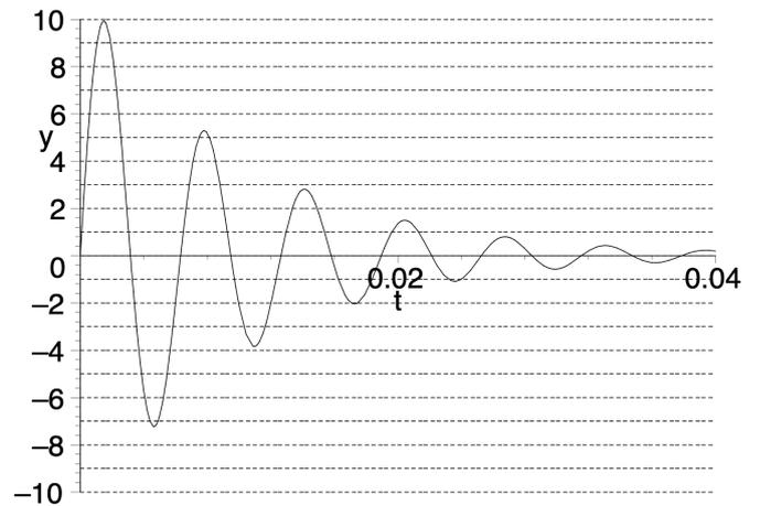
1. La tension  $u(t)$  représentée peut-elle être la tension aux bornes du condensateur? De la bobine? De la résistance?
