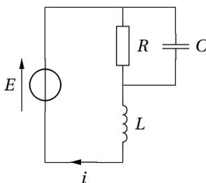
1. Déterminer l'équation différentielle vérifiée par  $i$ .
