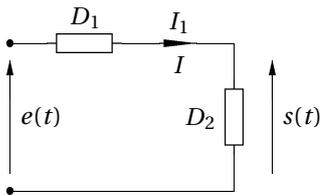
Quand  $e(t)$  est sinusoïdale, on obtient un filtre passe-bande de fréquence de résonance  $f_0 = 1$  kHz et de bande passante  $\Delta f = 200$  Hz.
