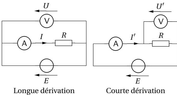
L'ampèremètre possède une résistance interne  $R_a$  non nulle et le voltmètre possède une résistance interne  $R_v$ . On donne  $R_a = 10 \Omega$  et  $R_v = 1 \text{ M}\Omega$ .
