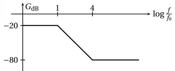
1. On donne  $R_1 = 90 \text{ k}\Omega$  et  $C_1 = 10 \text{ nF}$ . En utilisant le comportement du filtre en basse fréquence et en haute fréquence, déterminer  $R_2$  et  $C_2$ .
