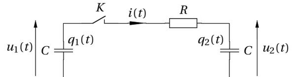
1. Que peut-on dire de la charge électrique totale portée par les deux condensateurs? En déduire une relation simple entre  $q_1(t)$  et  $q_2(t)$ .
