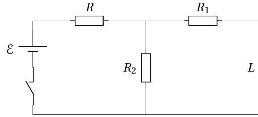
Lorsque l'on ferme l'interrupteur, le courant instantané fourni par le générateur est  $I_0 = 5 \text{ mA}$ , puis à l'état d'équilibre, il augmente à  $I_1 = 9 \text{ mA}$ .
