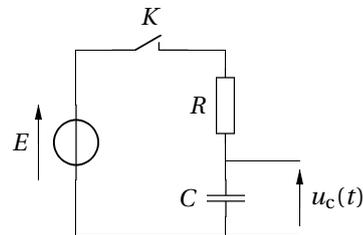
À l'instant  $t = 0$ , on ferme l'interrupteur  $K$ , le condensateur étant déchargé.
