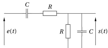
1. Déterminer sa fonction de transfert et tracer le diagramme de Bode.
