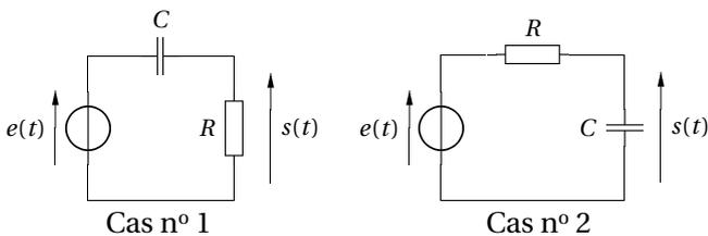
Le condensateur étant initialement déchargé, on étudie la réponse indicielle du circuit suivant :
