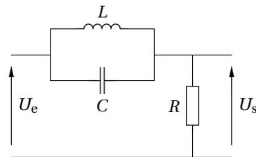
On prend  $L = 200$  mH. La tension d'entrée est la somme de la tension utile dont le spectre s'étend de 0 à 20 kHz et de la tension parasite composée d'une seule raie à 50 Hz.
