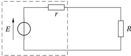
1. Exprimer la puissance  $P$  reçue par le résistor  $R$  en fonction de  $E$ ,  $r$  et  $R$ .
