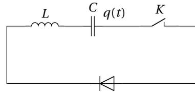
La diode est idéale. Initialement le condensateur est chargé, avec  $q(0) = q_0$ , et aucun courant ne circule.
