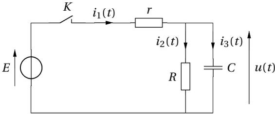
1. Déterminer toutes les grandeurs électriques du circuit juste après la fermeture de l'interrupteur (à  $t = 0^+$ ).
