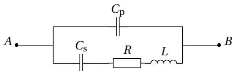
On note  $Z$  l'impédance complexe de ce dipôle, et on donne le graphe représentant le module de l'impédance de ce dipôle en fonction de la fréquence :
