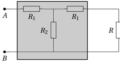
1. Pour une certaine valeur  $R_0$  de la résistance  $R$ , la résistance d'entrée — c'est-à-dire la résistance équivalente entre les bornes  $A$  et  $B$  — est égale à  $R_0$ . Exprimer  $R_0$  en fonction de  $R_1$  et  $R_2$ .
