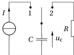
La résistance  $R = 20,0 \Omega$  modélise un circuit d'éclairage à LED qui restera allumée tant que  $u_c(t) > 1,50 \text{ V}$ .
