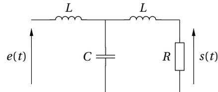
2. Exprimer la fonction de transfert  $H(j\omega)$  sous la forme de l'inverse d'un polynôme en puissance de  $(j\omega)$ .
