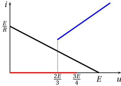
On voit alors que quand la lampe est éteinte, on a  $i_{\text{géné}} > i_{\text{néon}} = 0$  et  $u(t)$  croît, tandis que quand la lampe est allumée,  $i_{\text{géné}} < i_{\text{néon}}$  et  $u(t)$  décroît.
