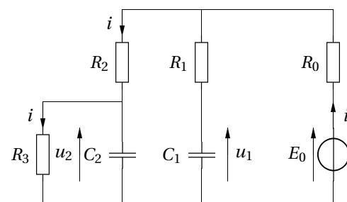
Le courant  $i = \frac{E_0}{R_0 + R_2 + R_3}$  circule dans les résistances  $R_0$ ,  $R_2$  et  $R_3$ .
