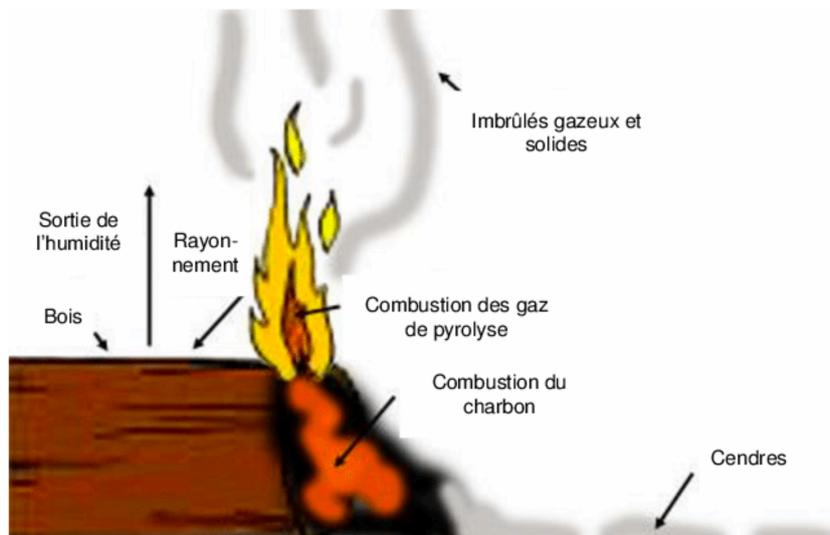
FIGURE II-1 – Différentes phases de combustion du bois
