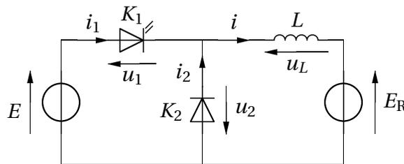
L'interrupteur  $K_1$  est un transistor commandé avec un rapport cyclique  $\alpha$  : il est fermé pour  $0 \leq t < \alpha T$  et ouverte pour  $t \leq \alpha T < T$ .
