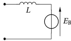
1. Cet élément se comporte-t-il comme une source de tension ou une source de courant? Peut-on alors le connecter directement à une source de tension?
