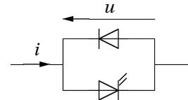
Déterminer la caractéristique courant-tension de ce dipôle, en précisant la commutation commandée.
