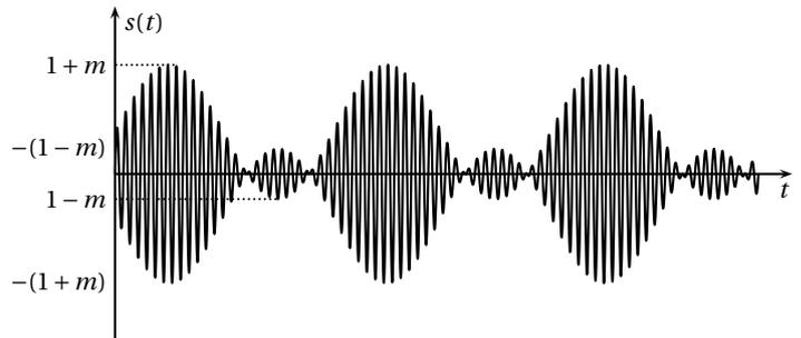
Donner le graphe du signal \$s(t)\$ pour \$m < 1\$. Que se passe-t-il si \$m > 1\$?
