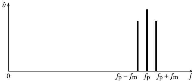
avec \$f\_p = 500\$ kHz, \$f\_p + f\_m = 500,2\$ kHz et \$f\_p - f\_m = 499,8\$ kHz. Le filtre passe-haut de fréquence de coupure \$f\_c = 500,1\$ kHz ne laisse passer que la fréquence la plus élevée. On a donc en sortie le signal
