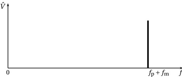
➤ On parle de modulation à bande latérale unique car le spectre ne comporte plus la porteuse, et ne comporte que la bande latérale supérieure du spectre de \$v(t)\$.
