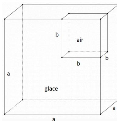
Conductivités thermique :  $\lambda_{\text{glace}} = 2,1 \text{ W} \cdot \text{m}^{-1} \cdot \text{K}^{-1}$  et  $\lambda_{\text{air}} = 0,022 \text{ W} \cdot \text{m}^{-1} \cdot \text{K}^{-1}$ .
