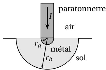
La prise de terre se décompose ainsi en deux résistances hémisphériques  $R_m$  et  $R_s$ , la première en métal de rayon intérieur  $r_a$  et de rayon extérieur  $r_b$ , la seconde associée au sol de rayon intérieur  $r_b$  et de rayon extérieur infini. Elle est destinée à recevoir un courant  $I$ , supposé indépendant du temps et descendant, provenant d'un paratonnerre.
