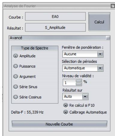
**Re calcul si F10** relance le calcul du spectre si une nouvelle acquisition est réalisée.
