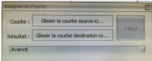
La touche F6 permet d'ouvrir la fenêtre permettant de réaliser une analyse spectrale du signal.
