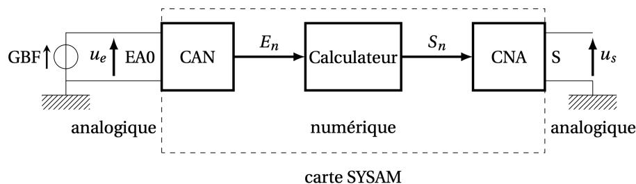
Le signal est généré par un GBF; son acquisition se fait en utilisant l'entrée EA0 de l'interface Sysam, et la restitution du signal calculé se fait en utilisant la sortie SA1.
