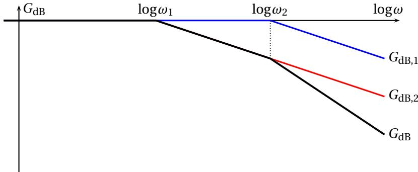
Avec  $Q = 1/3$ , on obtient  $f_1 = 0,382f_0 = 60,8$  Hz et  $f_2 = 2,62f_0 = 417$  Hz, soit  $\log f_1 = 1,78$  et  $\log f_2 = 2,62$ .
