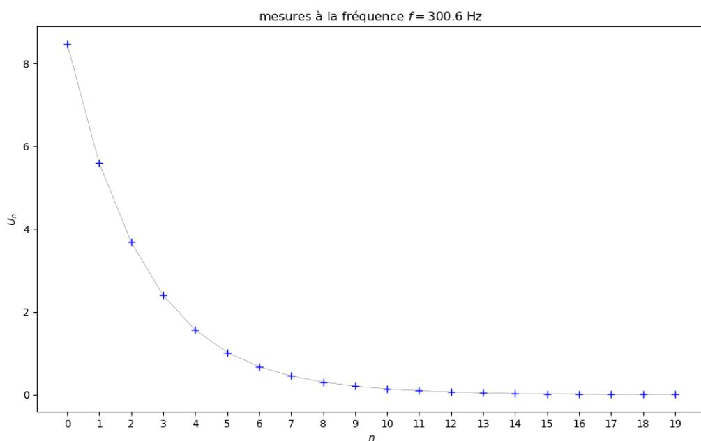
L'amplitude de la tension décroît tout au long de la ligne.
