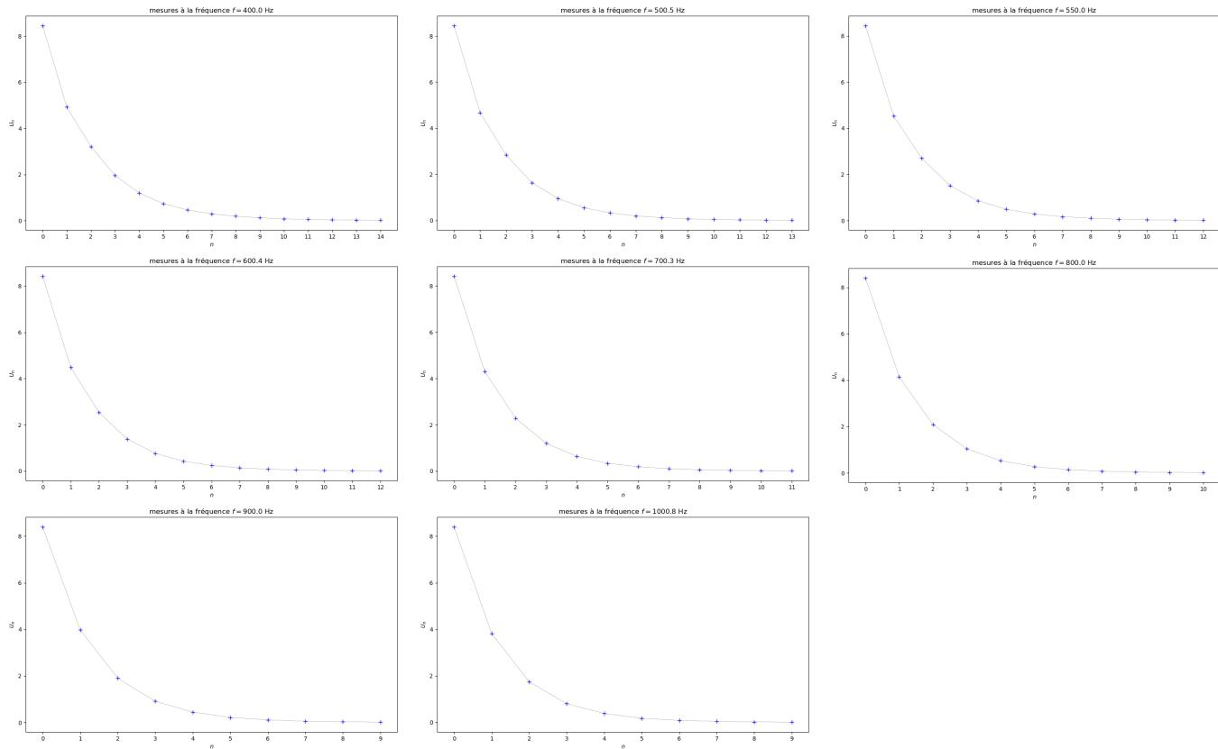
On constate que la décroissance de l'amplitude est d'autant plus rapide que la fréquence est élevée.
