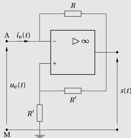
Lorsque l'ALI fonctionne en régime linéaire, on a  $u_e(t) = -R i_e(t)$  : vu des bornes A et M, le dipôle se comporte comme une résistance négative  $-R$ .
