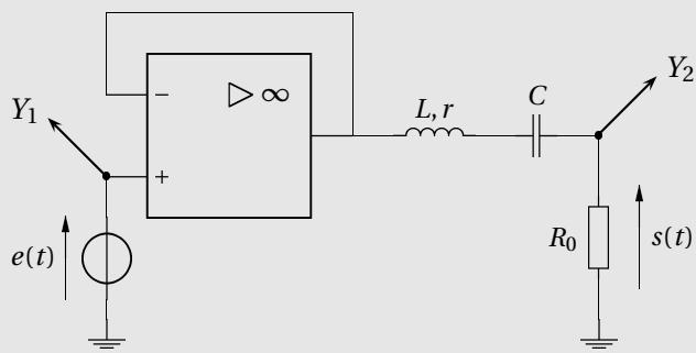
$R_0$  : boîte à décades de résistances $C$  : boîte à décades de condensateurs $L, r$  : bobine à noyau de fer réglableGBF : délivre  $e(t)$  créneau avec  $f = 20$  Hz $e_{\min} = 0$  V,  $e_{\max} = E = 10$  V
