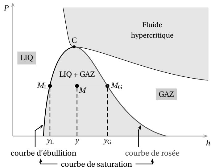
On représente la pression  $P$ , en échelle logarithmique le plus souvent, en fonction de l'enthalpie massique  $h$ . Les flèches indiquent la direction dans laquelle la grandeur constante sur la courbe augmente.
