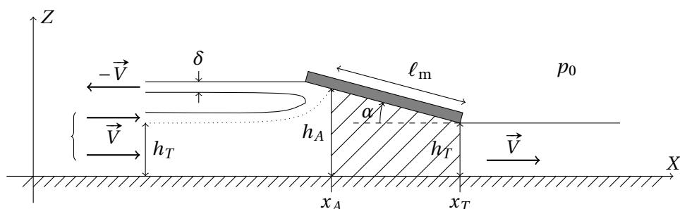
10. On note  $p_A$  la pression en  $x = x_A$ , soit  $p_A = p(x_A)$ . Montrer que la composante selon l'axe  $x$  de la résultante des forces s'exerçant sur  $\Sigma$  peut s'écrire  $(p_A - p_0)h_A L - F_x$ .
