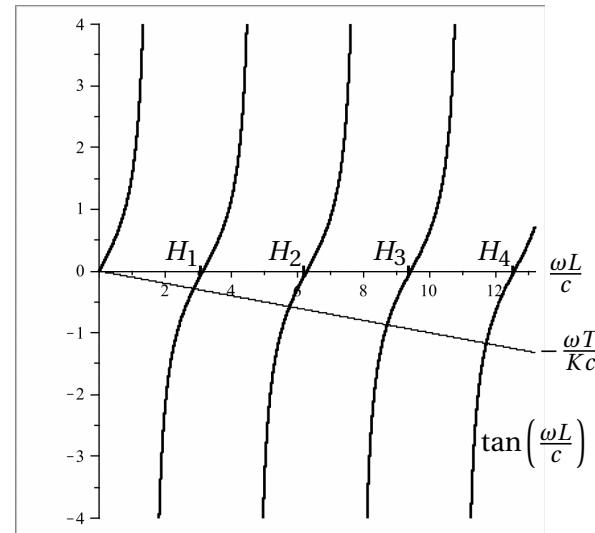
Les fréquences propres sont données par l'intersection des deux courbes. Les points correspondant aux harmoniques, de pulsations  $n\omega_1$  dans le cas de l'extrémité rigide, sont notés  $H_n$ . On voit sur le graphe que  $\omega_n < n\omega_1$  : l'**effet d'une extrémité élastique est d'abaisser les fréquences propres**.
