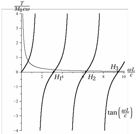
Les fréquences propres sont données par l'intersection des deux courbes. Les points correspondant aux harmoniques, de pulsations  $n\omega_1$  dans le cas de l'extrémité rigide, sont notés  $H_n$ . On voit sur le graphe que  $\omega_n > n\omega_1$  : l'**effet d'une extrémité massive est d'élever les fréquences propres**.
