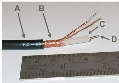
Les deux conducteurs sont séparés par un isolant (C), le plus souvent en téflon ou en polyéthylène. L'ensemble est entouré d'une gaine isolante (A), en PVC, polyéthylène, téflon ou caoutchouc synthétique.
