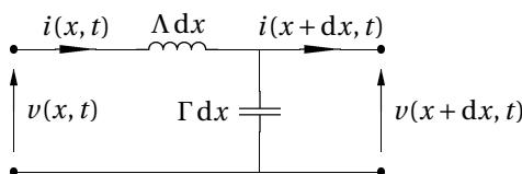
1. Établir les équations couplées vérifiées par  $u(x, t)$  et  $i(x, t)$ , et en déduire l'équation d'onde vérifiée par la tension et le courant, en précisant l'expression de la célérité  $c$ .
