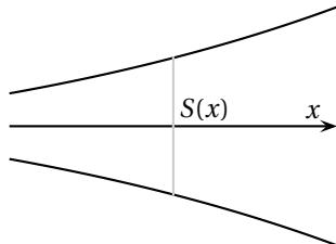
Au repos, la pression vaut  $P_0$  et la masse volumique  $\mu_0$ . On désigne par  $u(x, t)$  le déplacement élémentaire de la section d'abscisse  $x$ ,  $v(x, t)$  la vitesse de déplacement de cette section selon  $Ox$  et  $p(x, t) = P(x, t) - P_0$  la surpression à l'abscisse  $x$ .
