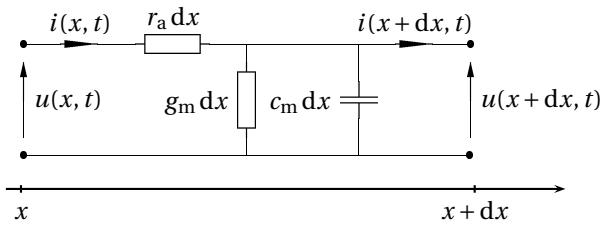
**1.** Déterminer les équations aux dérivées partielles vérifiées par  $u(x, t)$  et  $i(x, t)$ , puis celle vérifiée par  $u(x, t)$  seulement. On envisage dans la suite une solution sous forme d'onde plane pseudo-progressif harmonique  $u(x, t) = u_0 e^{j(\omega t - kx)}$ .
