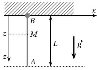
La corde est verticale ; l'axe des  $z$  est orienté vers le bas et l'origine est à l'extrémité  $B$ . L'axe  $Ox$  est dans un plan horizontal. La position d'un point  $M$  de la corde est repérée par sa cote  $z$  dans un référentiel galiléen lié à  $B$ .
