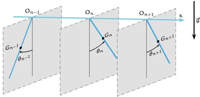
Chaque pendule est une barre homogène de longueur  $L$ , de masse  $m$ , fixée à l'axe de rotation  $Ox$  au point  $O_n$  d'abscisse  $x_n = nd$ .
