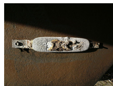
anode sacrificielle corrodée
