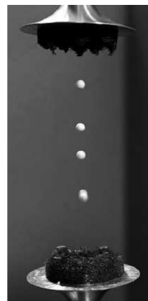
FIGURE I-1 – À gauche : lévitation acoustique de particules de polystyrène expansé. À droite : schéma de principe du dispositif de lévitation acoustique.
