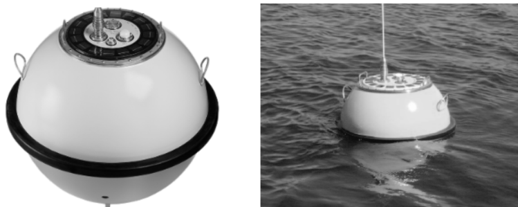
FIGURE III-1 – Photographies d'une bouée houlographe Waverider
