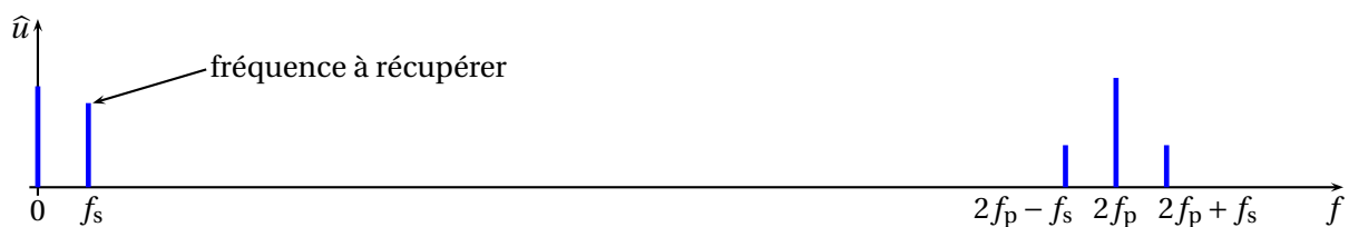
FIGURE 10 — Démodulation par détection synchrone : spectre de u(t) = p_m \times p(t) (signal modulé de la fig. 10)
