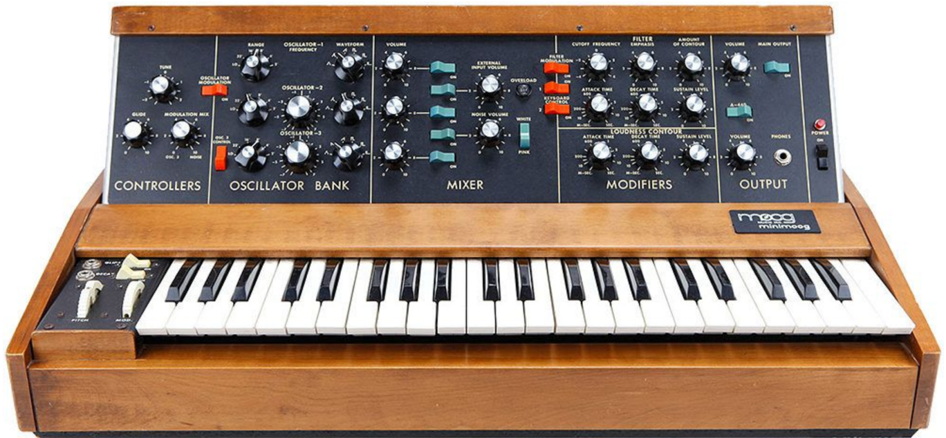
FIGURE II-1 – Minimoog 44 touches sorti en 1970, l'un des premiers synthétiseurs analogiques portables équipés d'un clavier numérique.
