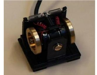
Le gyromètre est un capteur de vitesse angulaire.
