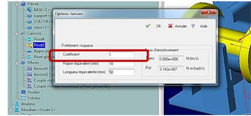
Editer la courbe de l'angle  $\beta$  : si elle est encore oscillante c'est que l'amortissement est mal réglé car dans la réalité le gyro n'oscille pas.
