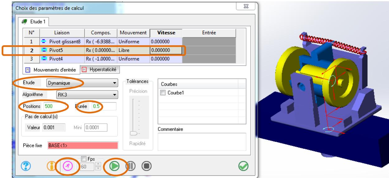
La liaison pivot stator/support doit être laissée « libre ».
