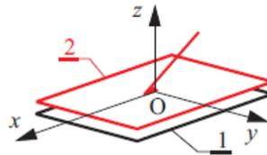
Le plan 2 possède une rotation selon  $\vec{z}$  par rapport à 1. 2 ne transmet donc aucun moment à 1 selon l'axe  $\vec{z}$  :  $\overline{M}_O(2 \rightarrow 1) \cdot \vec{z} = 0$ . En revanche 2 ne peut pas tourner par rapport à 1 selon l'axe  $\vec{x}$ , « ça bloque » à cause de la forme plan sur plan. Donc 2 peut transmettre un moment à 1 selon  $\vec{x}$  :  $\overline{M}_O(2 \rightarrow 1) \cdot \vec{x} \neq 0$ . Idem selon  $\vec{y}$ .
