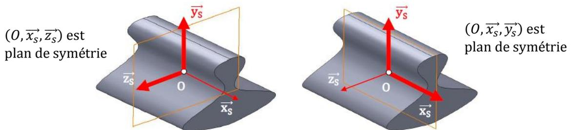
Deux plans de symétrie orthogonaux, annulent les trois produits d'inertie. La matrice
