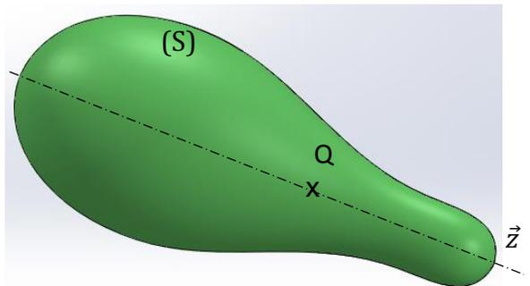
Interprétation : la notion d'axe principal d'inertie est très utilisée pour l'équilibrage des solides en rotation.
