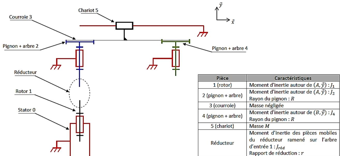
Chacun des composants possède une « une inertie » : masse pour un composant translatant, moment d'inertie pour un composant tournant.
