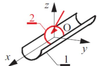
Exemple 2 : liaison hélicoïdale d'axe  $(O, \vec{x})$  de pas réduit  $p^* = \frac{p}{2\pi}$  (en rad/s)
