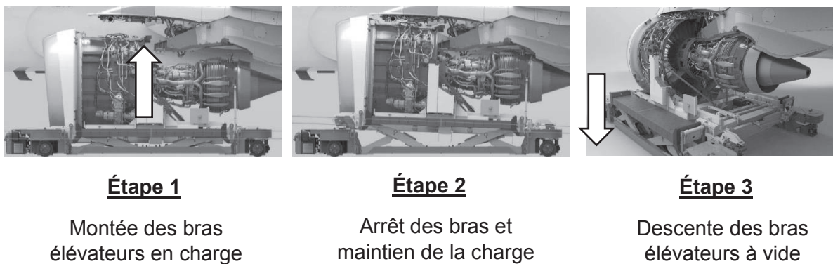
Figure 5 - Étapes pour la pose d'un moteur
