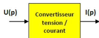
Le courant qui alimente le moteur est issu d'une conversion tension – courant de facteur  $K_{UI} = 0,17$  A.V<sup>-1</sup>.
