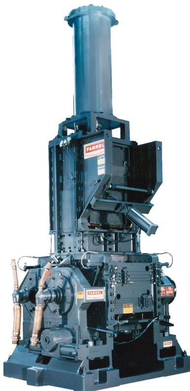
Un mélangeur interne à rotors engrenants est une machine utilisée dans l'industrie pour effectuer le mélange du caoutchouc et d'additifs divers. Il est, par exemple, utilisé dans la fabrication des pneumatiques.
