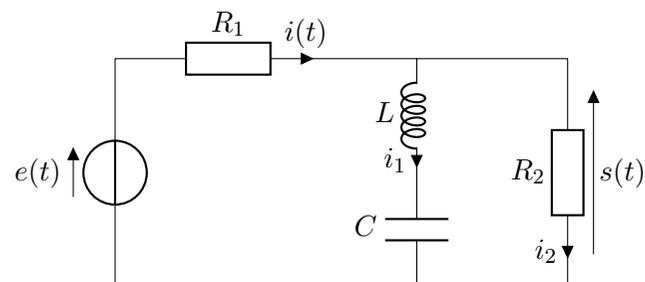
Le générateur de tension (GBF) fournit un signal  $e(t)$  sinusoïdal de pulsation  $\omega$ .
