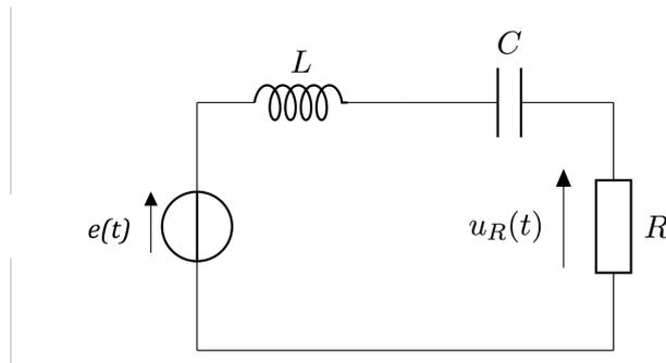
**Q11. (\*\*)** Déterminer la fonction de transfert  $H(j\omega)$  de ce circuit. L'écrire sous la forme canonique :
