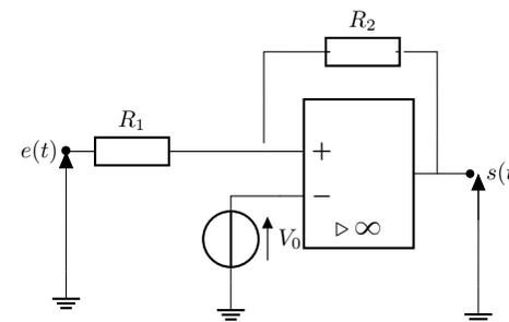
$V_0$  est une tension constante. On posera  $\alpha = \frac{R_1}{R_2}$ .
