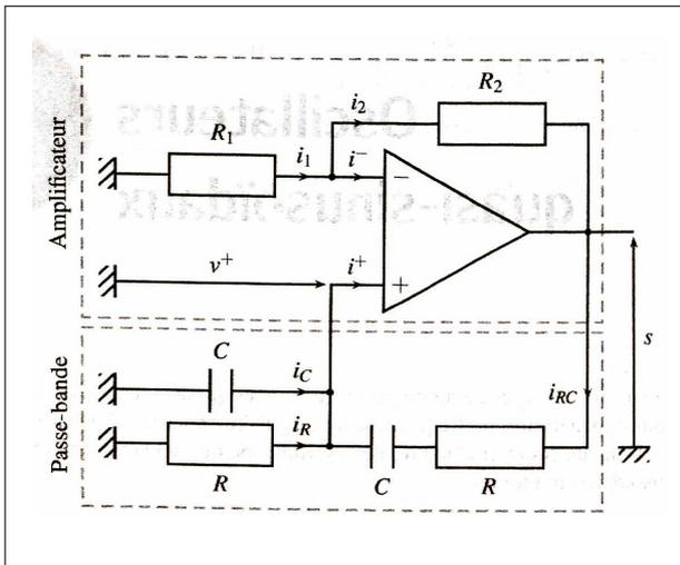
**Données :**  $R = R_1 = 1\text{ k}\Omega$ ,  $C = 470\text{ nF}$ ,  $R_2$  : résistance variable (de  $1\ \Omega$  à  $10\text{ k}\Omega$ )
